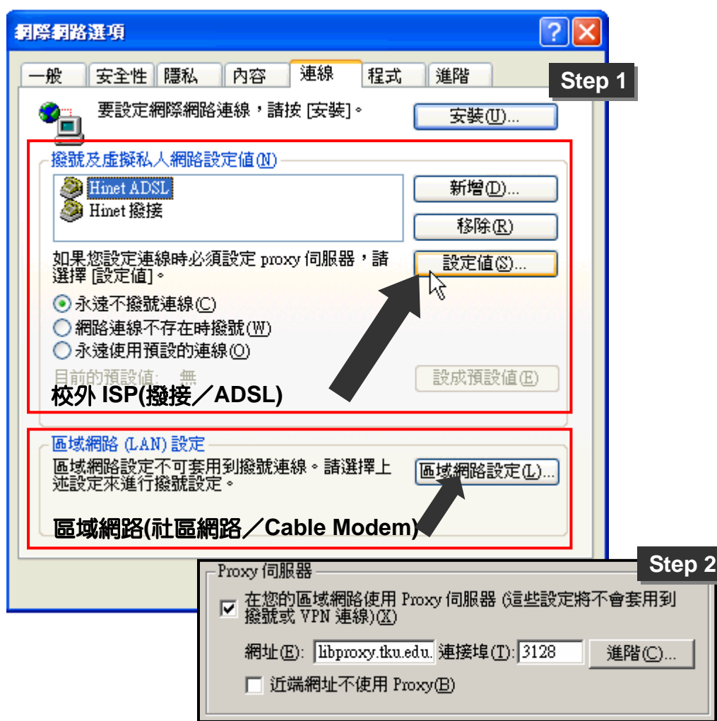
圖 28 校外連用電子化資源之瀏覽器的 Proxy 伺服器設定
